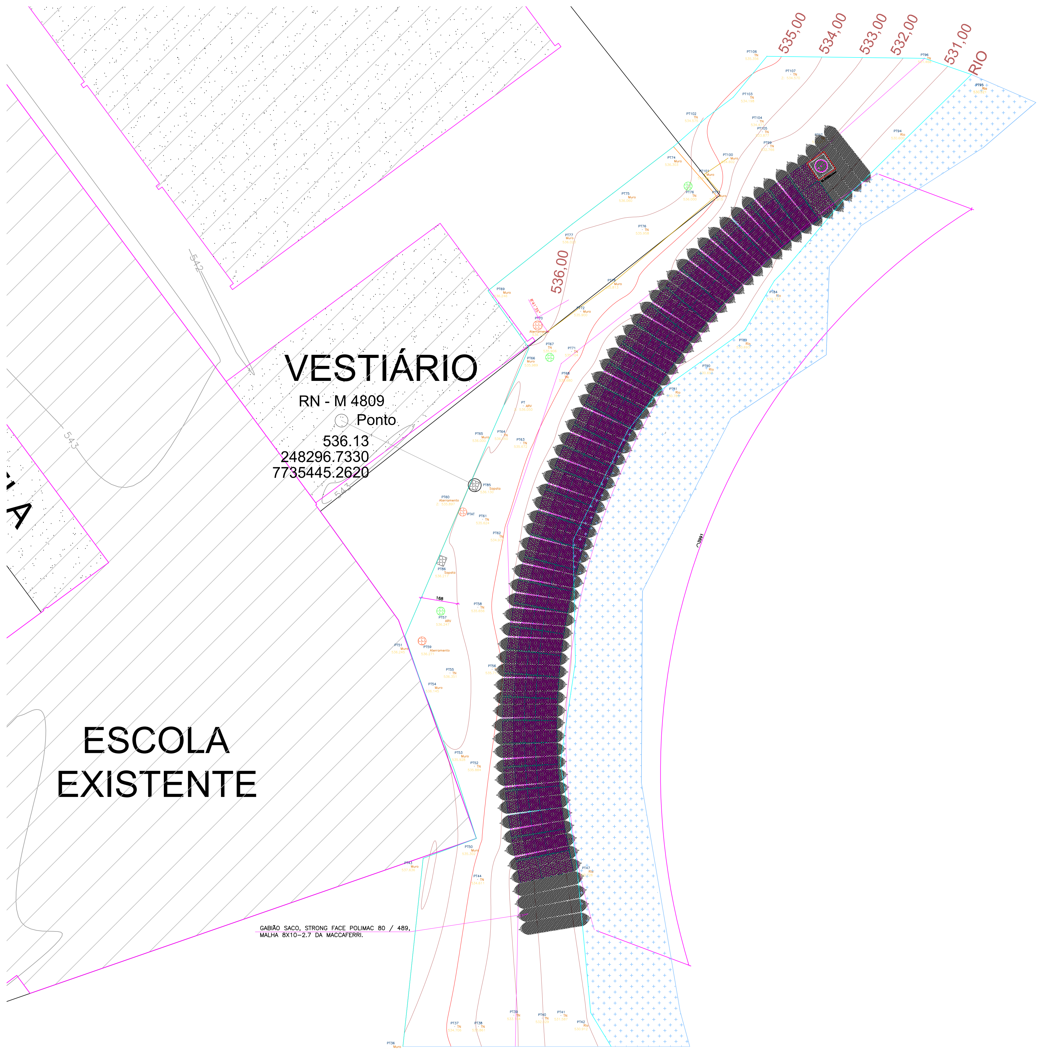
MURO DE CONTENÇÃO GABIÃO: PROJEÇÃO GABIÃO SACO
